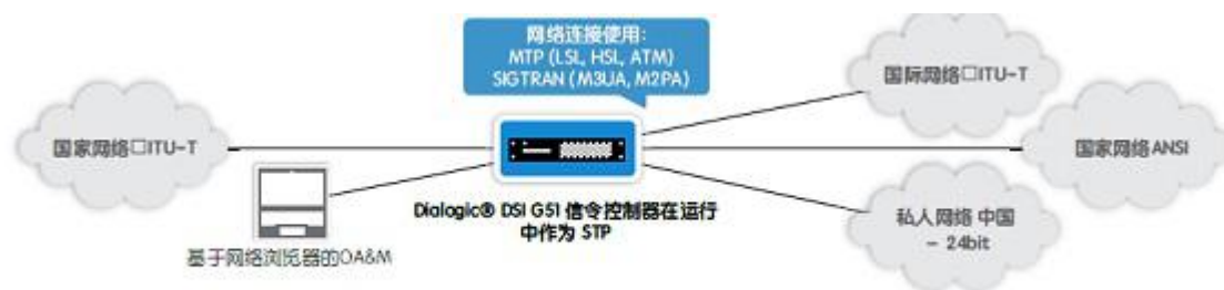
图1 Dialogic® DSI G51 信令控制器作为STP
